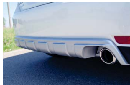
4 Kunststoffheckblende Aluminiumoptik SEAAFG3200 Zum Schutz des Fahrzeugs vor Steinschlag. Verstärkt die Offroad-Optik.
